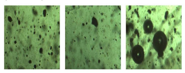
Fig-7: Microstructures a) 160°C b) 180°C c) 200°C (Magnification 630x)
